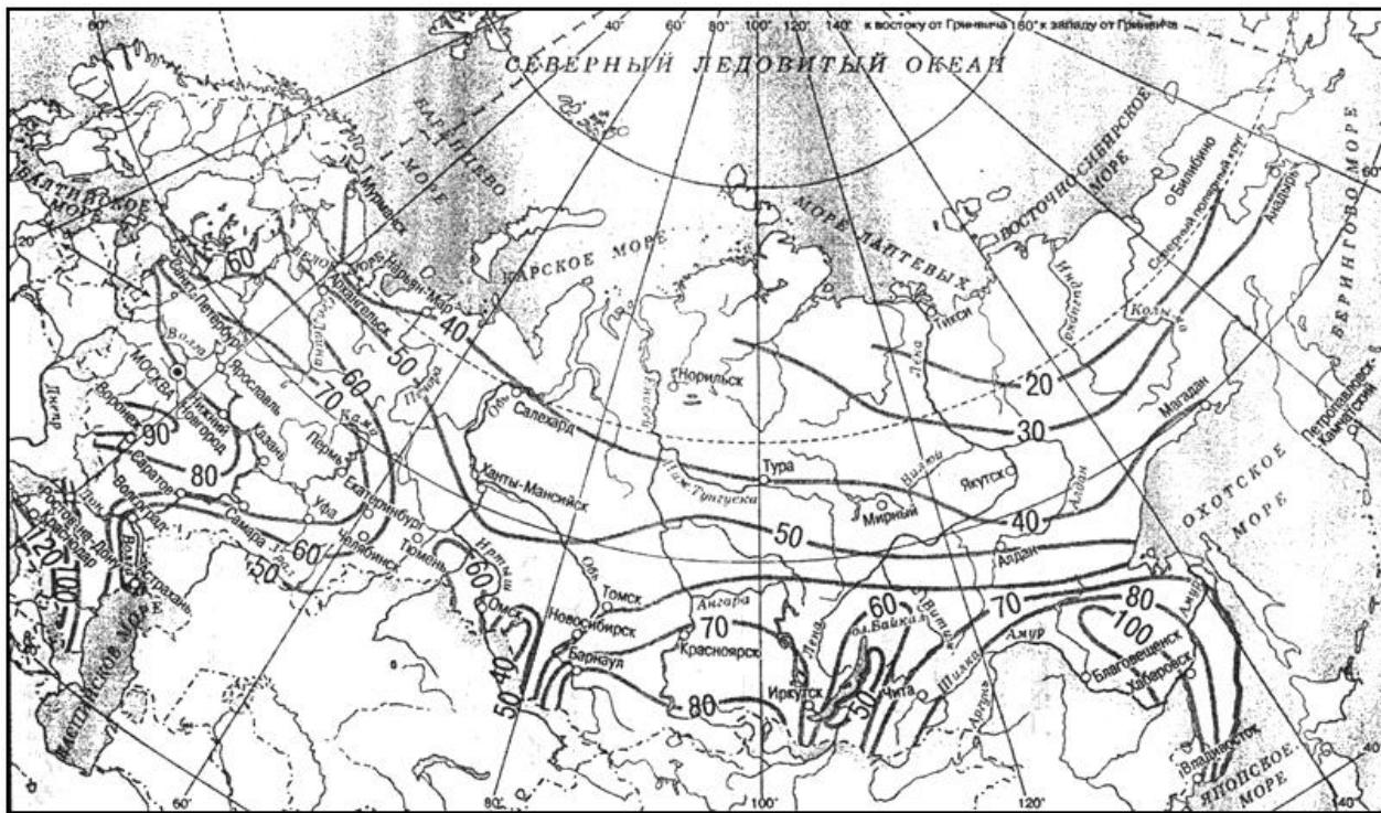
Рисунок Б.1 - Значение величин интенсивности дождя  $q_{20}$
